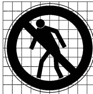
Предупреждающий знак ГОСТ 12.4.026-2015 (проход запрещен)
