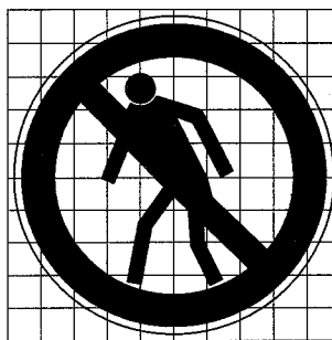
Предупреждающий знак ГОСТ 12.4.026-2015 (проход запрещен)
