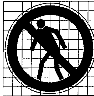
Предупреждающий знак ГОСТ 12.4.026-2015 (проход запрещен)
