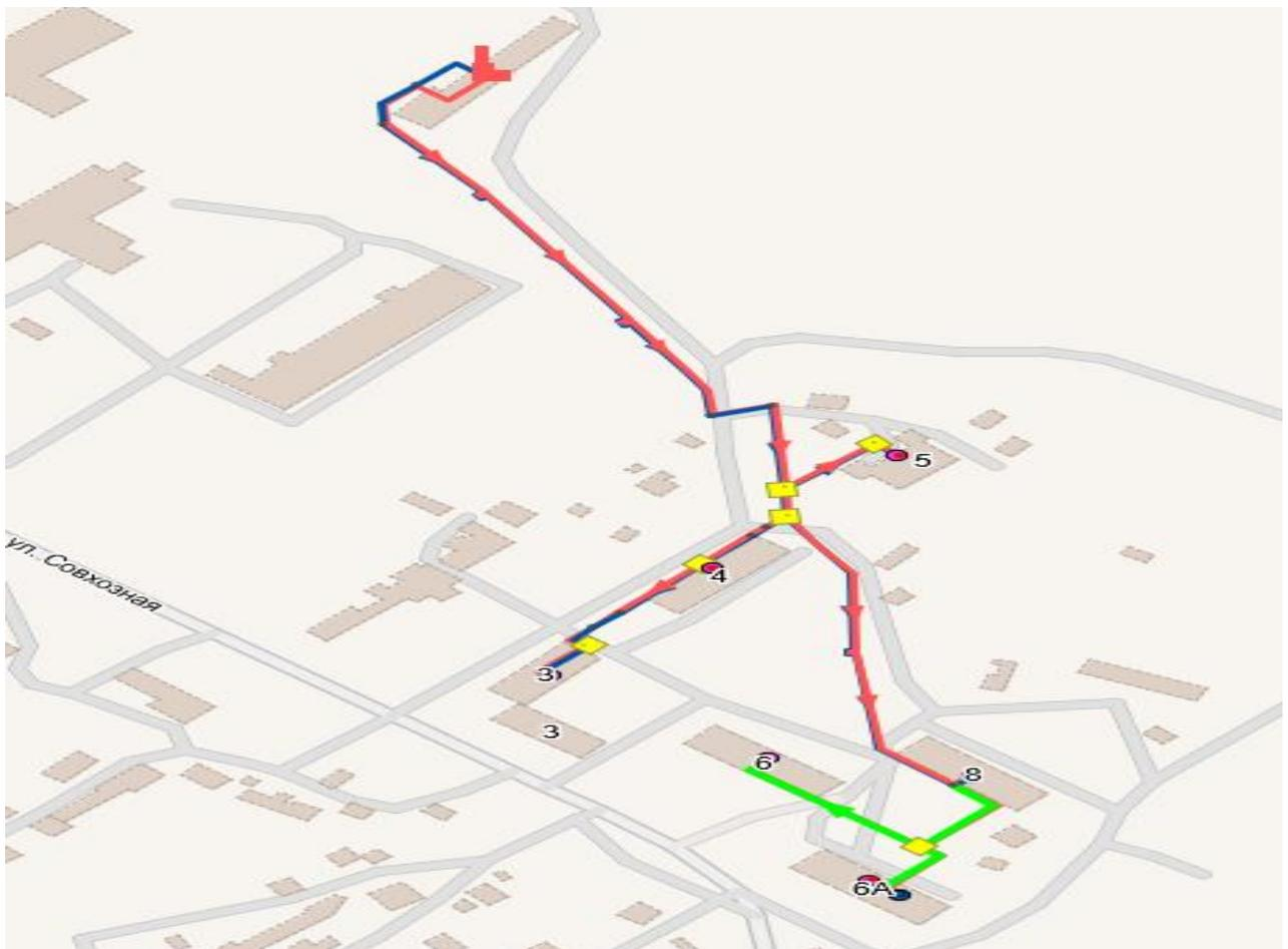
**Рисунок № 1. Визуализация отключения участков тепловых сетей на котельной в н.п.25 км железной дороги Мончегорск-Оленья.**
