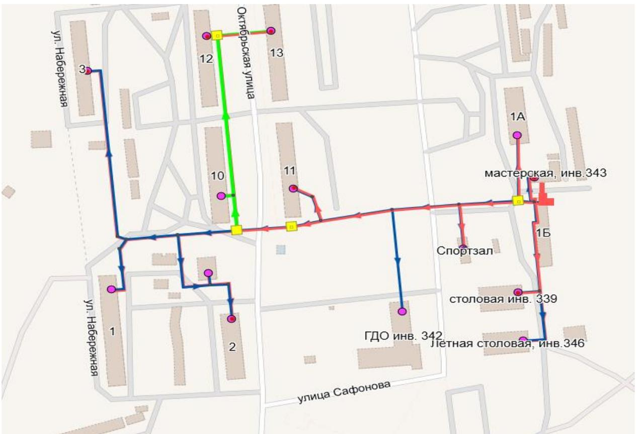
Рисунок № 3. Визуализация отключения участков тепловых сетей от котельной № 110 в н.п. 27 км железной дороги Мончегорск-Оленья.
